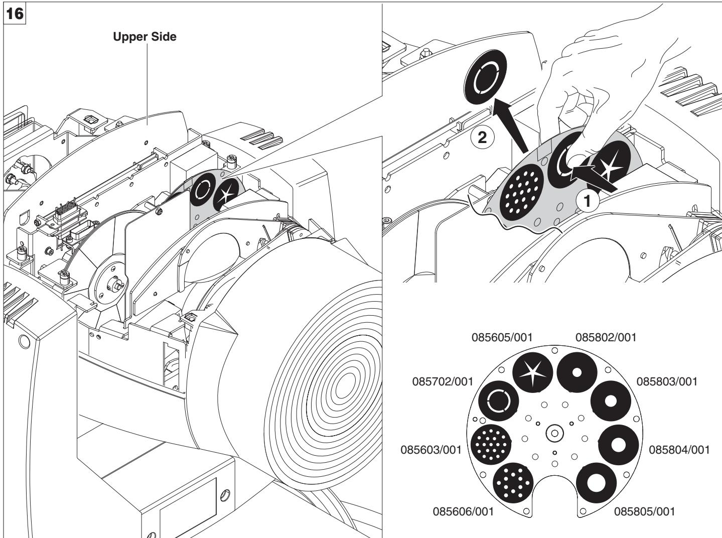
**I** Sostituzione gobo fissi ( $\varnothing$  31,5 mm - immagine max 25 mm - spessore max 1 mm) - Figura 16
