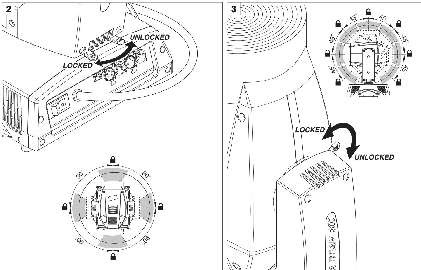
**I** Blocco e sblocco movimento PAN (ogni 90°) - Figura 2
